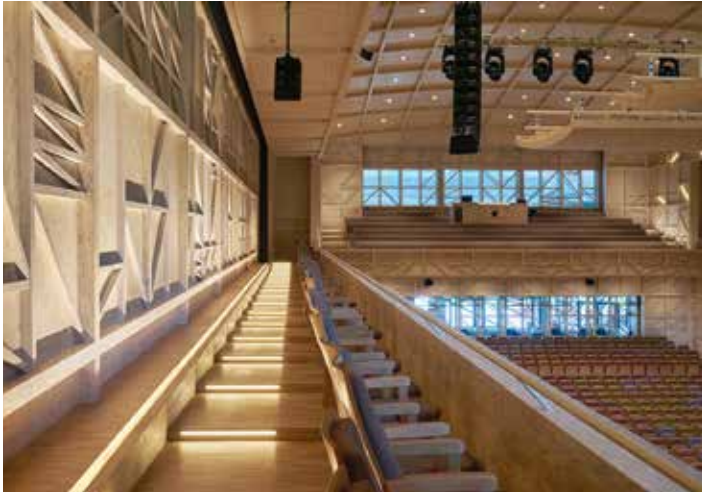
Konzertsaal der Paul & Henri Carnal Hall du Rosey in Rolle, entworfen von Bernard Tschumi, realisiert durch die Firma Schwab System. Mit OSB-verkleideten Wänden und linearen Elementen in Überstärke, um die Akustik des Saals zu perfektionieren. (© Corinne Cuendet)
