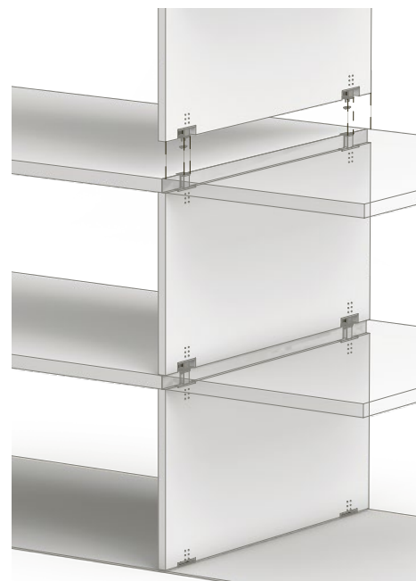
36 Kraftabtragung bei Innenwänden (Massivholzbau bzw. mit mehrlagigen Massivholzplatten) über Stahlteile. Anwendung bei vertikalen Druck- u. Zugkräften. Bei aussteifenden Wandscheiben sind die Horizontalkräfte durch zusätzliche Verbindungen z.B. über die Decken zu übertragen.
