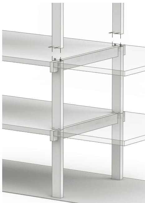
38 Kraftabtragung mit durchgehenden oder übereinander angeordneten Gabelstützen. Kraftabtragung über Längsholz oder Kontaktstöße, meistens jedoch in Verbindung mit mechanischen, eingeschlitzten Verbindungsmitteln. Dazwischen liegende Wandelemente, vertikal nicht tragend ausgebildet
