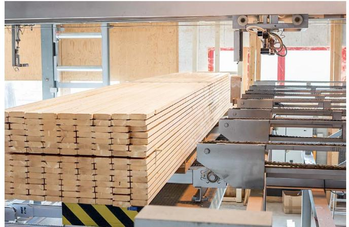
Gehobelte Lamellen zur Herstellung von Brettstapeln. [9]
