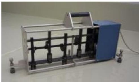
Figur 1: Norm-Hammerwerk. Quelle: Fraunhofer IBP
