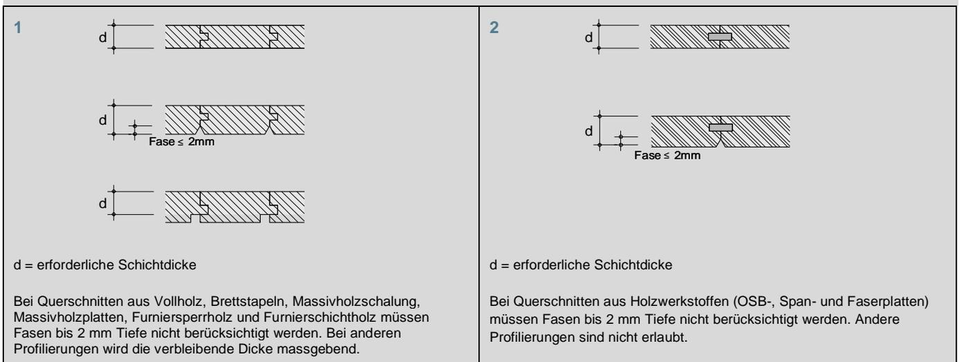
Abbildung 2: Massgebende Dicke bei Holz und Holzwerkstoffen
