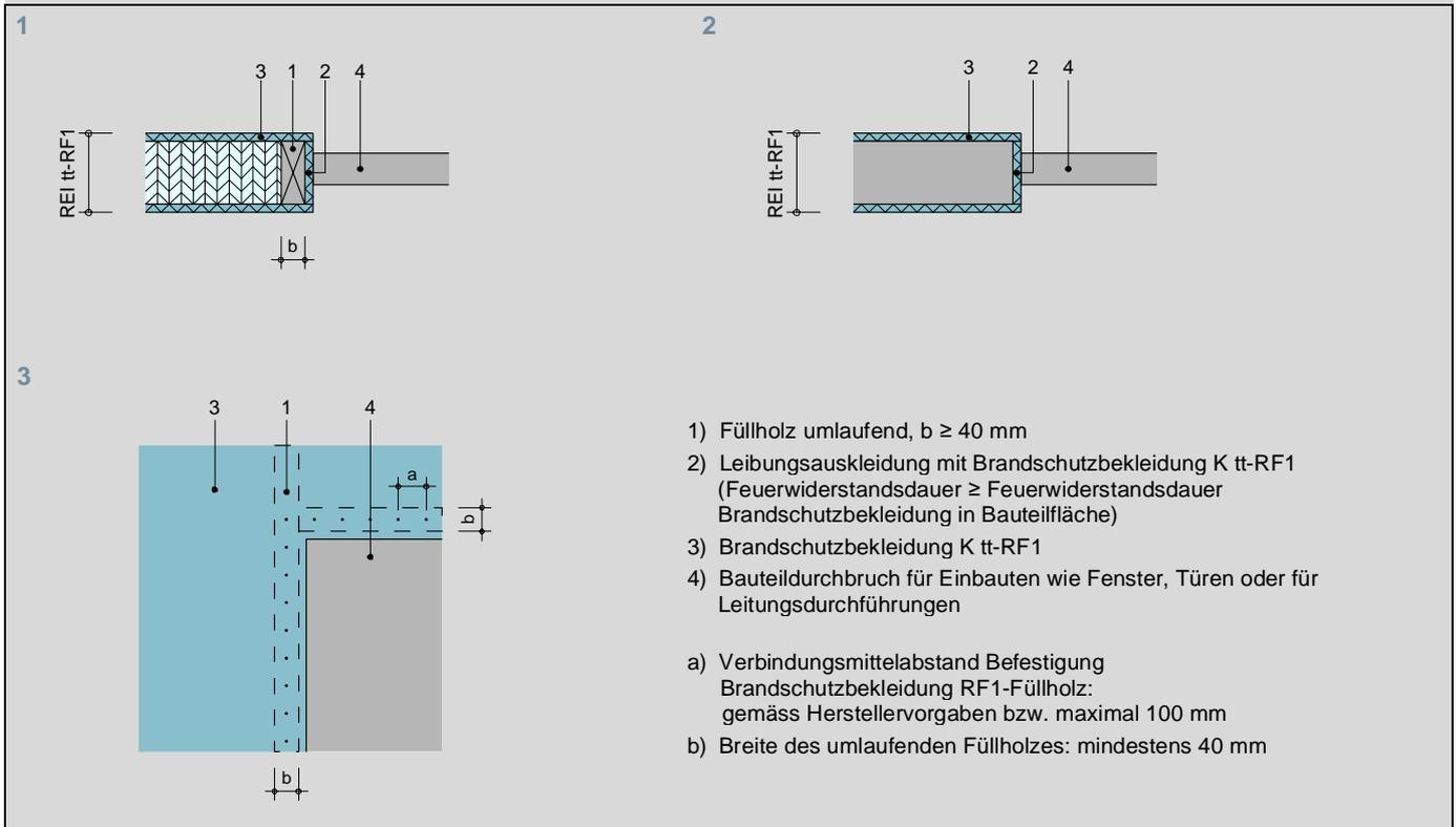
Abbildung 16: Ausbildung der Bauteilleibung bei Bauteilen RF1
