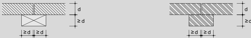
Des weiteren gelten Beplankungen als hinterlegt, wenn es sich bei der dahinterliegenden Schicht
