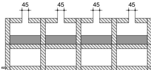
**Typ 4: eggo®-Schwerlastelement ES, Kalksplittschüttung unten 50 kg/m<sup>2</sup> oder 100 kg/m<sup>2</sup>**
