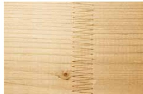
Assemblage longitudinal par enture et collage pour obtenir des éléments de grande longueur (bois abouté, contrecollé, lamellé-collé). (Photo : © Schmölzer, proHolz Austria/LIGNUM)
