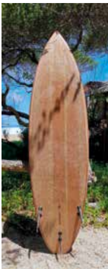
Wood'nShape gamme de surfs Gun – Hobbit – shortboard performance 6'3"-19"3/4-2"1/3 en peuplier et balsa. Fibre de lin sur le dessous et fibre de verre sur le dessus. (Photos : © Wood'nShape)
