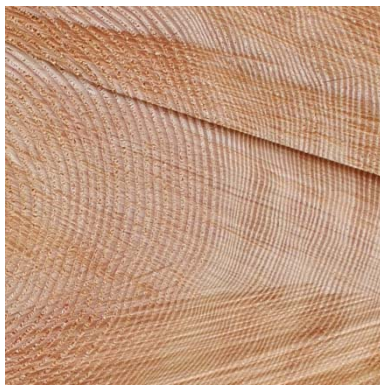
Illustration 1.3-12: Largeur des cernes: Peut varier fortement, mesure au petit bout.
