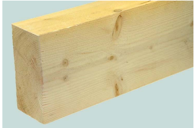
Figure 4.1-1: Bois massif en sapin de qualité normale (N), brut de sciage.
