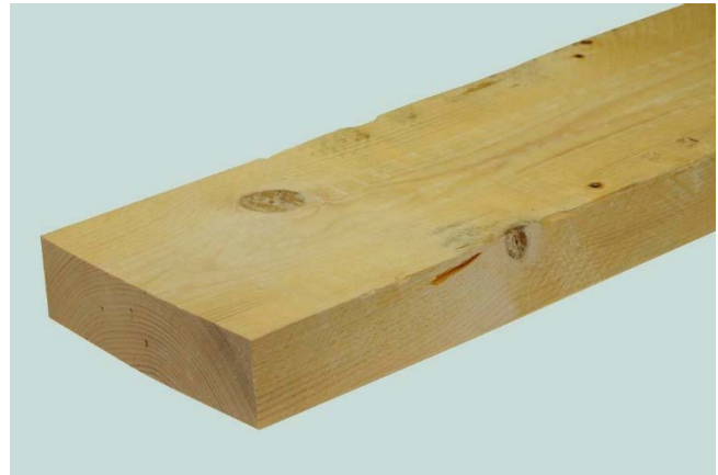
Figure 4.5-1: Lame en épicéa pour le lamellé-collé de qualité normale (N), brut de sciage.
