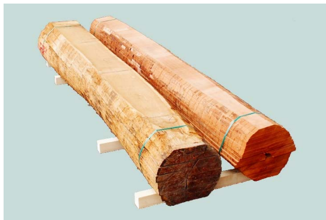
Figure 2.2-1: Planches de chêne ou de hêtre en plot.
