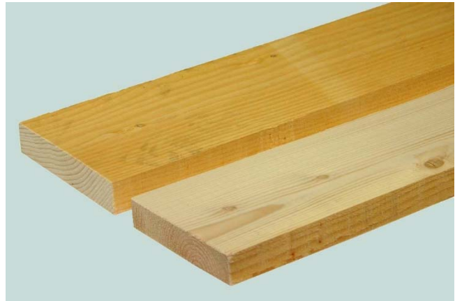
Figure 4.7-1: Planches de coffrage en sapin, brute de sciage (derrière) et rabotée une face (devant).
