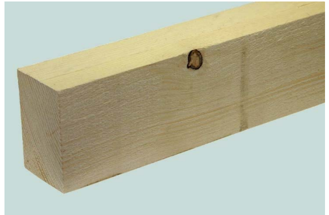
Figure 4.6-1: Carrelet de coffrage en sapin, brut de sciage.
