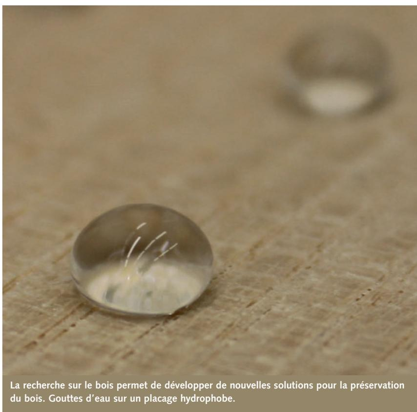
La recherche sur le bois permet de développer de nouvelles solutions pour la préservation du bois. Gouttes d'eau sur un placage hydrophobe.
