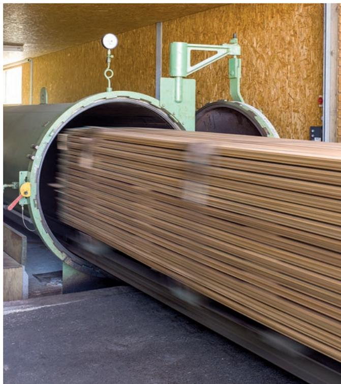
Autoclave per l'impregnamento sotto pressione
