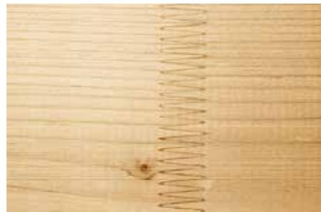
Verleimung in Längsrichtung, um besonders lange Elemente zu erhalten (keilgezinktes, verleimtes, laminiertes Holz). (Bild: © Schmölder, proHolz Austria/Lignum)
