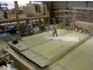
Les différents éléments d'une construction en bois sont fabriqués de manière partiellement automatisée dans un atelier de charpente à l'abri des intempéries.
