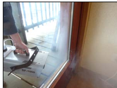
Repérage des fuites (fumée et infrarouge)
